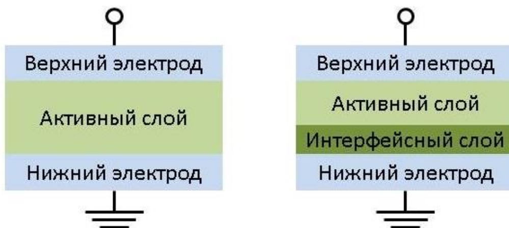
Рисунок 27. Два типа МДМ структур. Слева МДМ структура без дополнительного слоя, справа структура с интерфейсным слоем, упрощающим переключение состояний проводимости.
