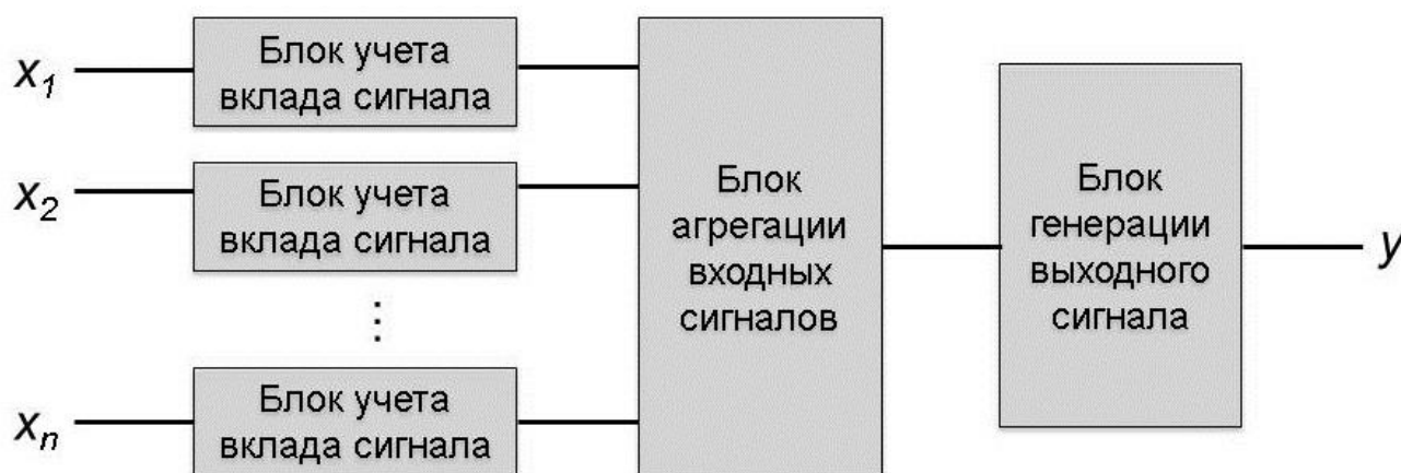
Рисунок 1. Обобщенное представление искусственного нейрона. x_1 - x_n – входные сигналы, y – выходной сигнал нейрона.
