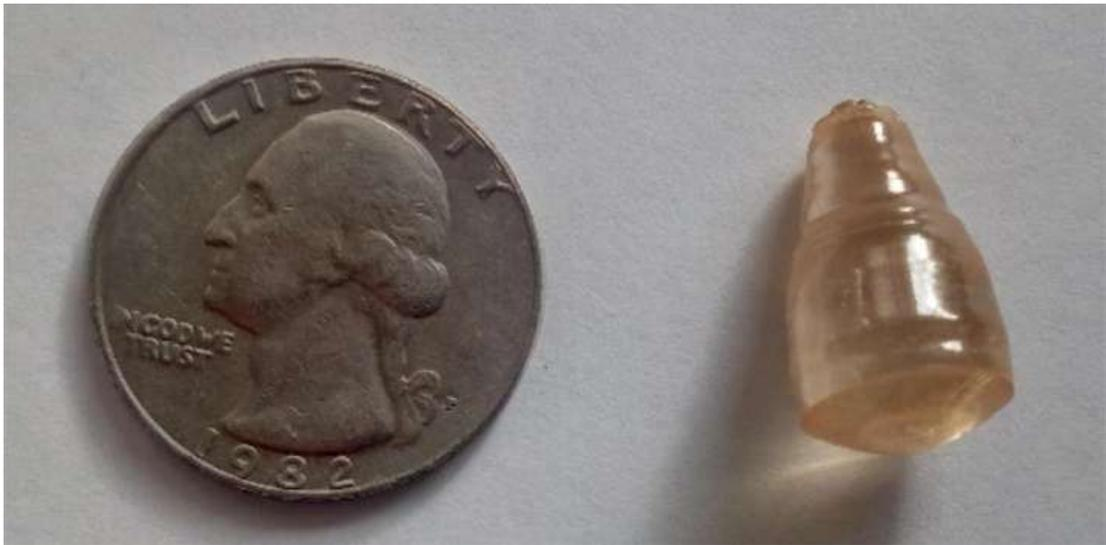
Рисунок 9 – Кристалл  $\text{LiNb}_{0.57}\text{Ta}_{0.43}\text{O}_3$  выращенный методом Чохральского при адаптированных параметрах ростового процесса
