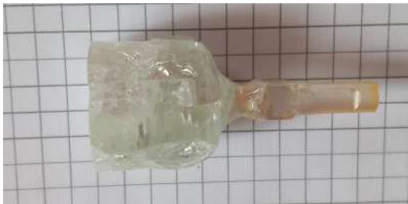
Рисунок 7 – Кристалл  $\text{LiNb}_{0.88}\text{Ta}_{0.12}\text{O}_3$ , выращенный методом Чохральского при стандартных параметрах процесса выращивания кристаллов  $\text{LiNbO}_3$
