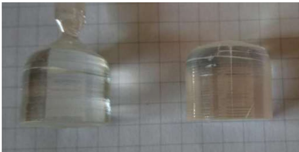
Рисунок 1 – Кристаллы \text{LiNb}_{0.88}\text{Ta}_{0.12}\text{O}_3 , выращенные методом Чохральского при адаптированных параметрах ростового процесса
