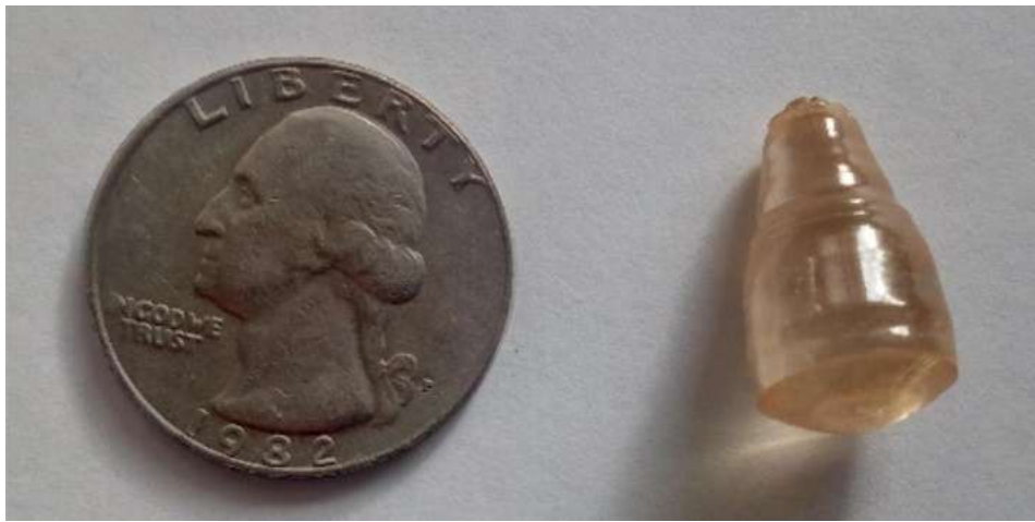
Рисунок 2 – Кристалл \text{LiNb}_{0.57}\text{Ta}_{0.43}\text{O}_3 , выращенный методом Чохральского при адаптированных параметрах ростового процесса
