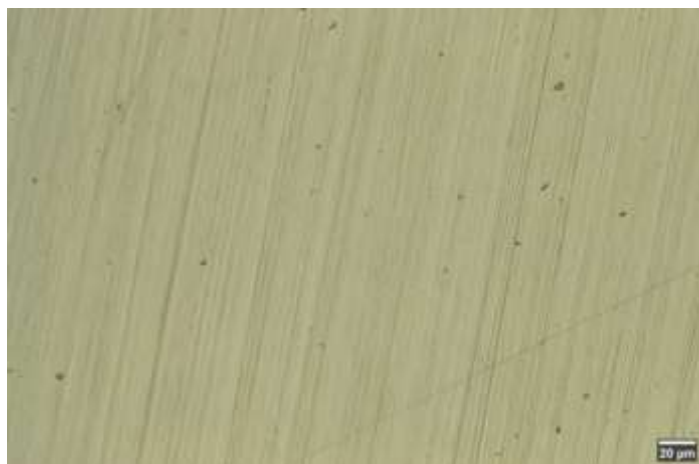
Рисунок 5 – Микроструктура кристалла \text{LiNb}_{0,5}\text{Ta}_{0,5}\text{O}_3 после адаптированной технологии монодоменизации
