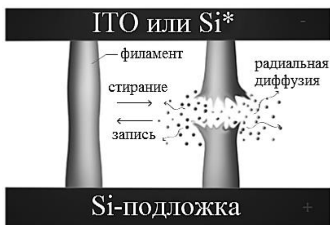
Рисунок 1.23. Процесс разрушения филамента в \text{SiO}_x , полученном магнетронным напылением [50]
