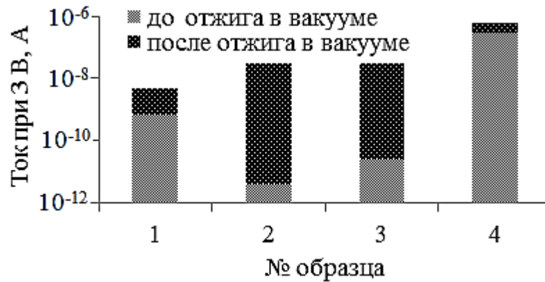
Рисунок 2.15. Влияние термического отжига структуры в вакууме на ток чтения логического «0»
