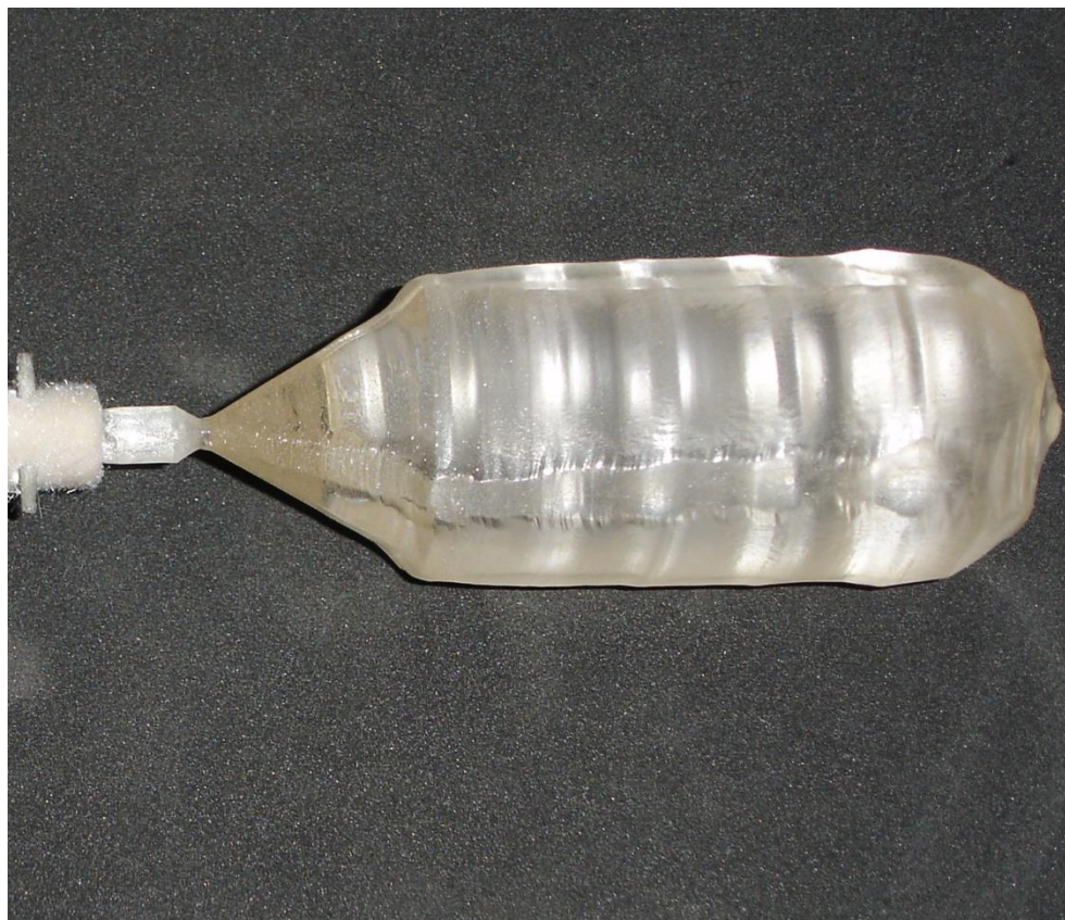
Рисунок 11 – Кристалл КГТС, выращенный вдоль направления [100]
