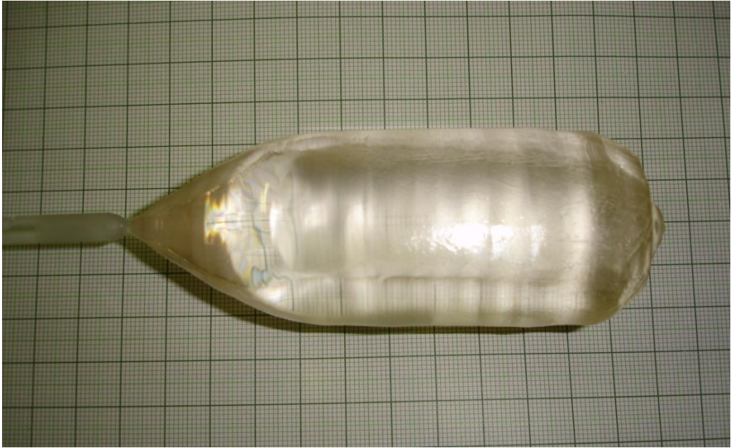
Рисунок 12 – Кристалл КГТС, выращенный вдоль направления [010]
