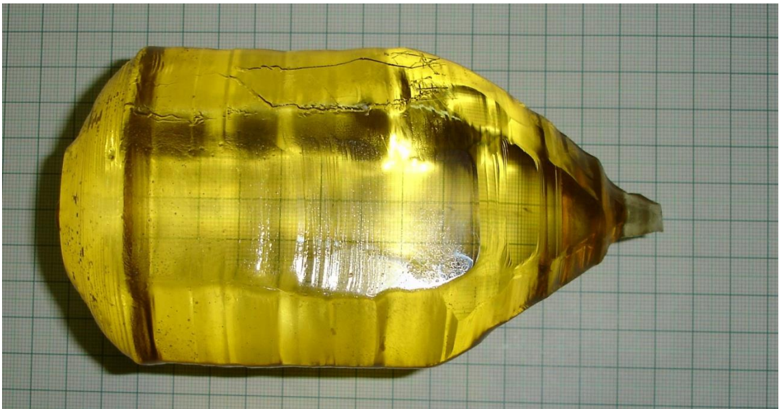
Рисунок 13 – Кристалл КГТС весом 2,2 кг
