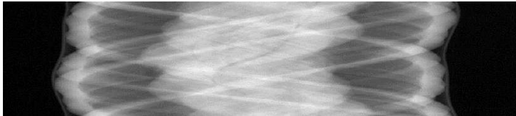
Рисунок 5.18 — Пример скорректированной синограммы (с подавленными полосовыми артефактами).
