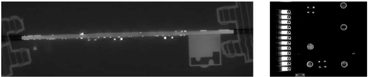
Рисунок 5.72 — Два виртуальных сечения цифрового изображения объекта, представленного на рис. 5.71. Слева - сечение в плоскости XY, справа - сечение в плоскости XZ.
