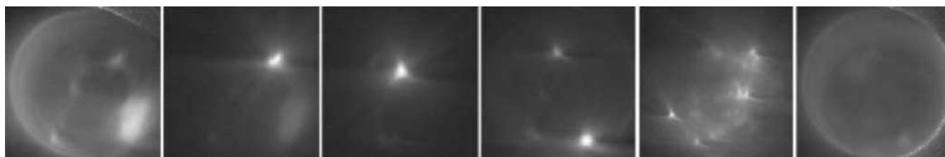
Рисунок 4.10 — Карты пространственного распределения элементов в тестовом капилляре. Горизонтальные сечения цифрового 3D изображения.
