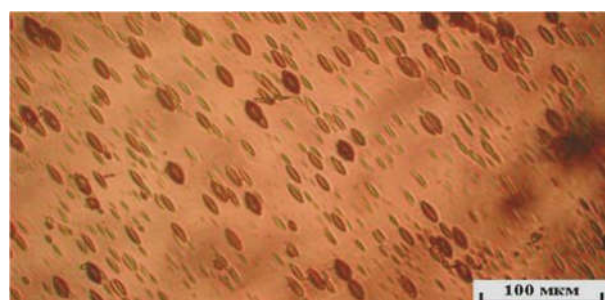
Рисунок 2.10 – Вид ямок травления при фокусировке на противоположные полярные поверхности неподвижной пластины ЛГТ Y - среза
