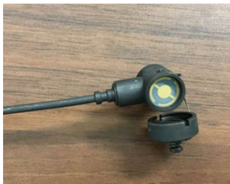
Рисунок 5.9 – Приспособление для измерения резонатора при температуре
