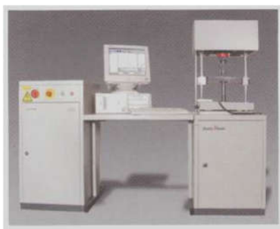
Рисунок 2.21 – Высокочастотный пульсатор Amsler 20 HFP 5100
