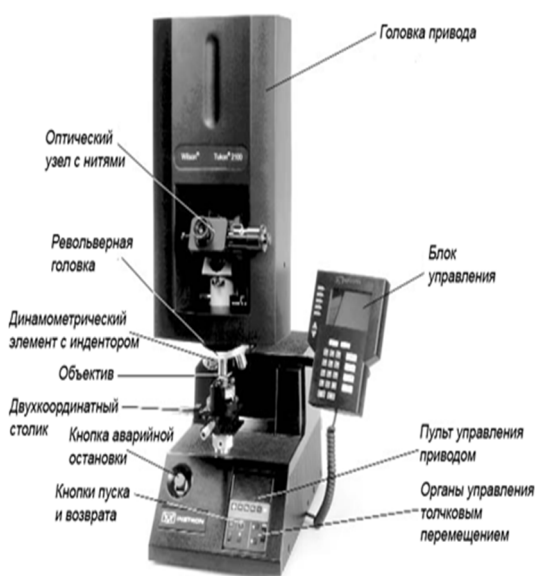
Рисунок 2.16 – Полуавтоматический микротвердомер Tukon® 2100
