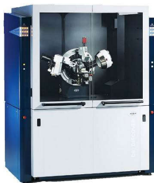
Рисунок 2.14 – Внешний вид дифрактометра D8 Discover
