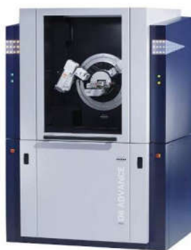
Рисунок 2.19 – Внешний вид дифрактометра D8 Advance
