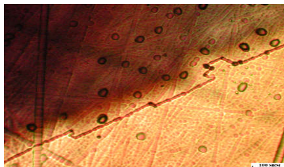
Рисунок 2.12 – Блоки и блочные границы в поляризованном свете в кристалле ЛГТ (X-срез)
