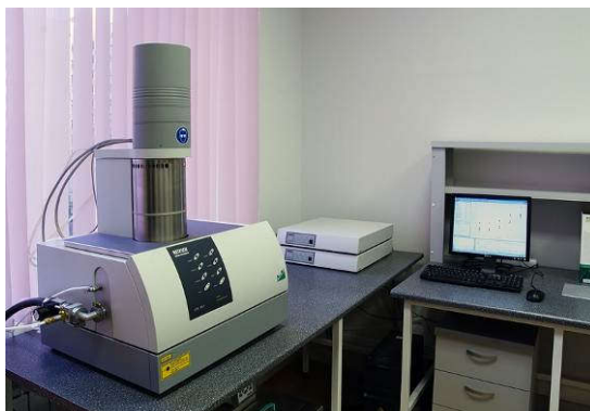
Рисунок 2.24 – Анализатор температуропроводности NETZSCH LFA 457 MicroFlash
