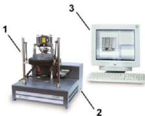
Рисунок 2.3 – Внешний вид атомно-силового микроскопа Solver P47. 1 – измерительный блок; 2 – контроллер; 3 – компьютер с интерфейсной платой и программным обеспечением
