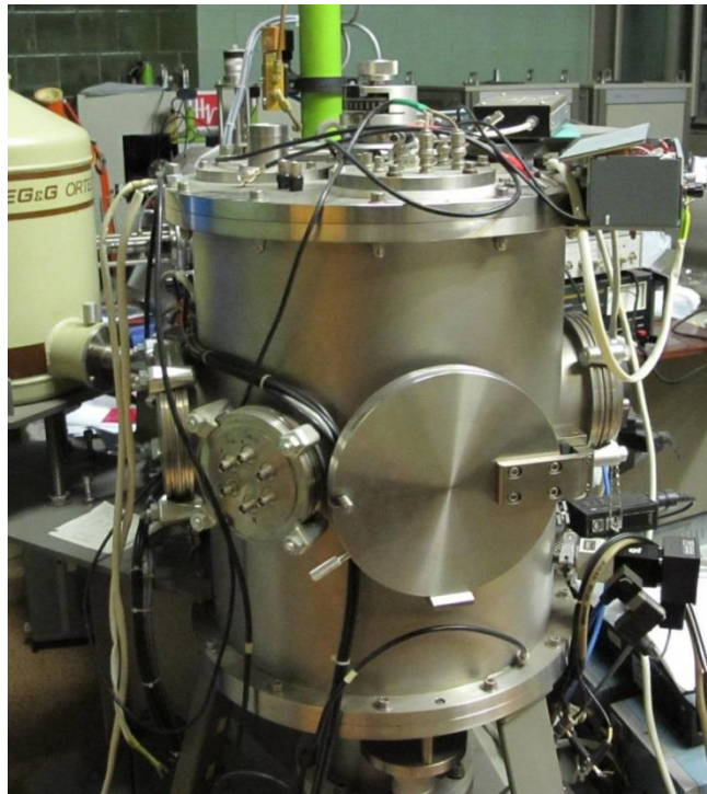
Рисунок 2.10. Приемная камера для исследований методом резерфордовского обратного рассеяния на базе ускорителя Ван де Граафа K2MV (HVEE)
